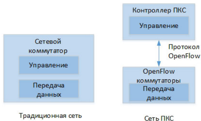
Рис. 1. Функции коммутаторов при различных подходах в построении сети
