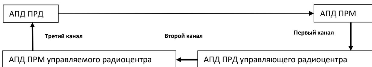
Рис. 1. Структура составного служебного канала управления (ССКУ)
